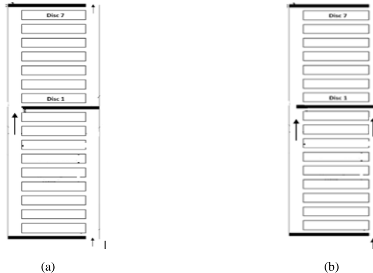
Figura 6.2 - Tipos de direcionadores: (a) guias alternadas e (b) guias internas/externas
