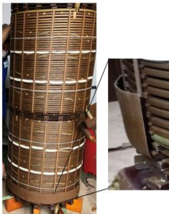
Figura 7.30 - Deslocamento da capa base - Cenário 5: (a) posição original; (b) posição modificada
