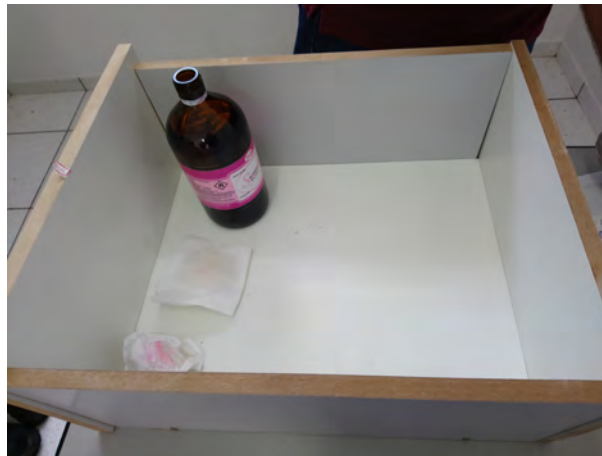
Figura A.2 – Estação de trabalho para manuseio dos ímãs e armazenamento e acetona para a limpeza
